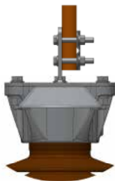
Fig. 16: the connection of an individual line conductor can be performed from above or from the side / Abb. 16: Der Anschluss eines einzelnen Netzleiters kann von oben oder von der Seite vorgenommen werden
