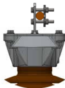
Fig. 16: the connection of an individual line conductor can be performed from above or from the side / Abb. 16: Der Anschluss eines einzelnen Netzleiters kann von oben oder von der Seite vorgenommen werden
